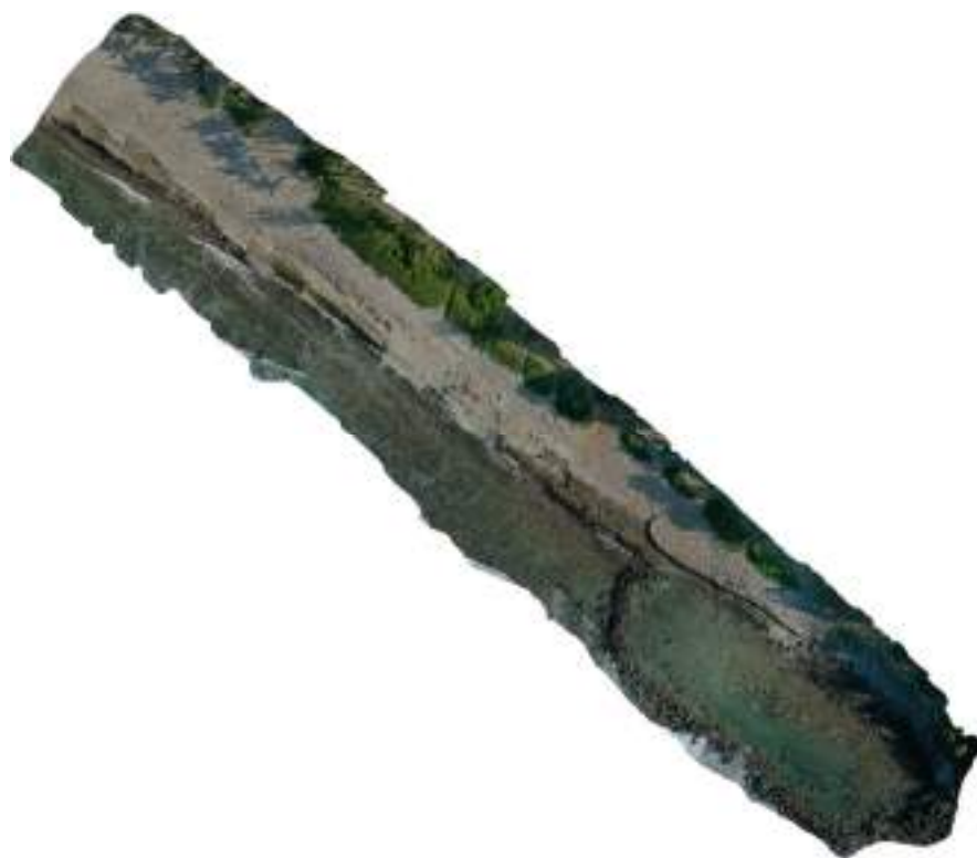
Figure 98 : Orthophoto produite à l'aide des images drones et du logiciel Agisoft Metashape Professional.
