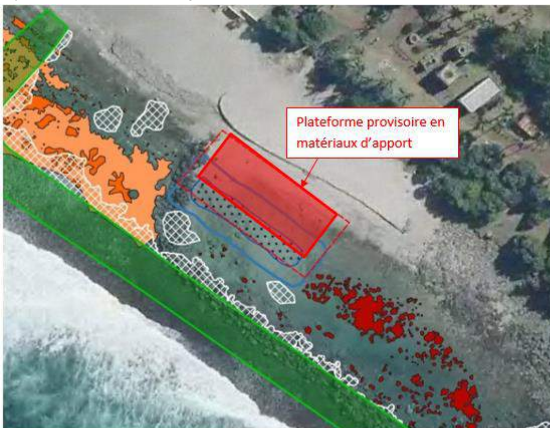
Figure 54 – Déroctage pour fosse d'apprentissage
