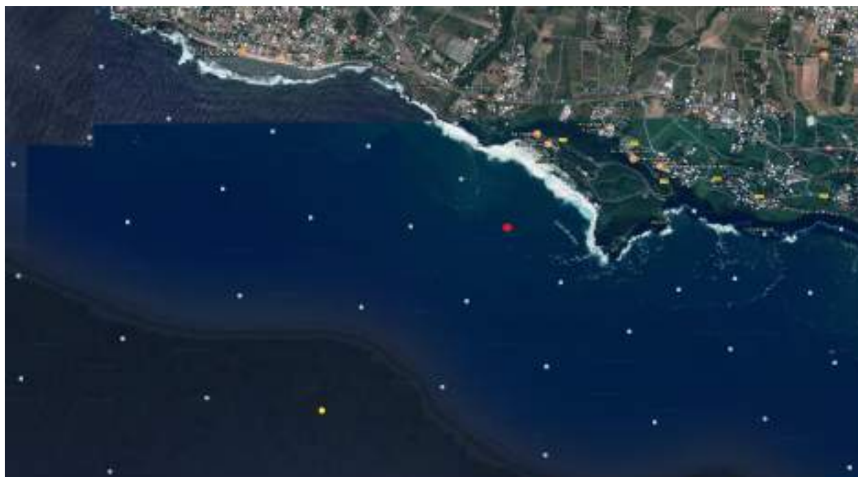
Figure 2-7 : Grille des états de mer Hydrorun (points cyans) aux abords de la zone de projet. Le point rouge représente le point sélectionné pour la caractérisation des conditions opérationnelles (point A). Le point jaune représente le point sélectionné pour la caractérisation des conditions extrêmes (point B).
