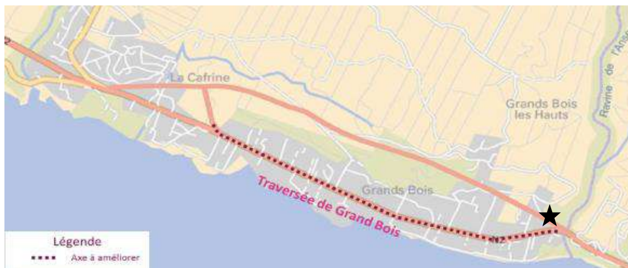
Figure 27 : Tracé prévisionnel du TCSP sur la section n°16 au niveau de Grand Bois (Source : Schéma Directeur NEO, février 2018)
